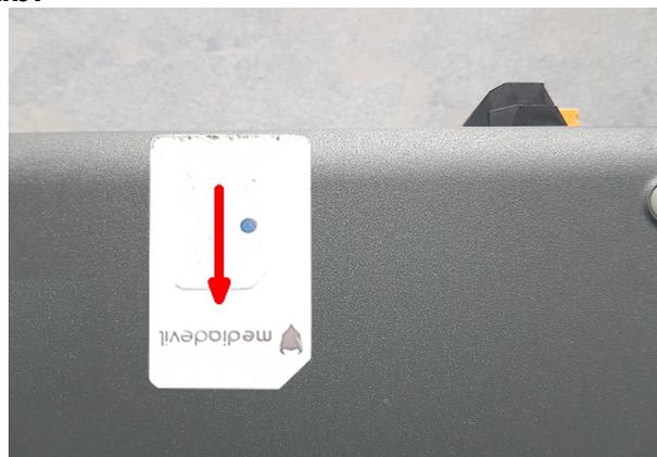
Die SIM-Karte mit der Kontaktseite nach unten (schräge Ecke vorne rechts) in den Slot einführen bis es klickt. Durch erneutes Drücken wird die Karte ausgelöst und kann herausgezogen werden.
