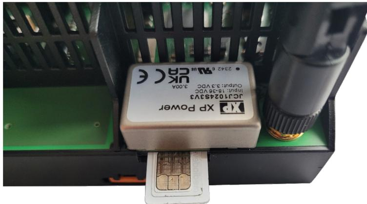
Die SIM-Karte mit Gefühl einschieben bis ein Widerstand zu spüren ist, lässt man die Karte los hört man ein leises Klicken. Zum Auslösen wird die SIM-Karte wieder reingedrückt bis zum Widerstand und los gelassen. Die Karte wird ausgeworfen.
