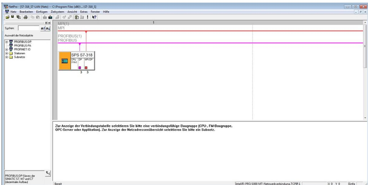
Machen Sie nun einen Doppelklick auf die SIMATIC 300/400 Station, auf welcher das LAN-Gerät aufgesteckt ist. Es öffnet sich nun der Hardware-Konfigurator. Dies sieht dann z. B. wie folgt aus:
