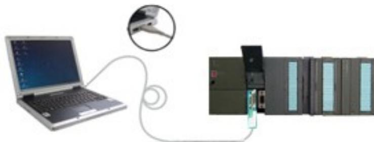
Stecken Sie Ihr USB-Gerät zunächst mal auf die PPI/MPI/Profibus-Schnittstelle Ihrer SPS. Falls an Ihrer Schnittstelle der SPS bereits ein Buskabel eingesteckt ist, können Sie sich, falls das Kabel über eine Diagnosebuchse verfügt, einfach noch zusätzlich oben auf diese darauf
