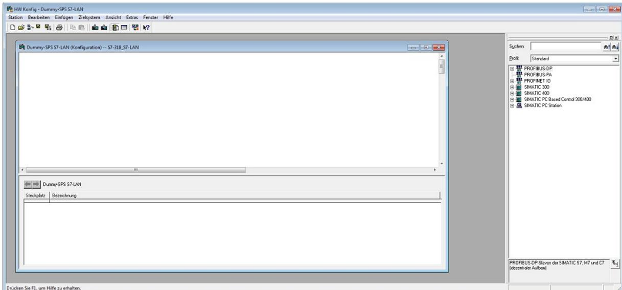
Hier müssen Sie nun zunächst eine Profilschiene (SIMATIC 300 → RACK-300 → Profilschiene) und anschließend eine SPS mit Netzwerk-Anschluss (z. B. SIMATIC 300 → CPU-300 → CPU 315-2 PN/DP → 6ES7 315-2EG10-0AB0 → V2.3) aus dem Katalog hinzufügen. Nun erscheint ein Dialog, in welchem Sie die Eigenschaften der Netzwerk-Schnittstelle eingeben müssen. Geben Sie hier die IP-Adresse und Subnetzmaske Ihres LAN-Geräts ein:
