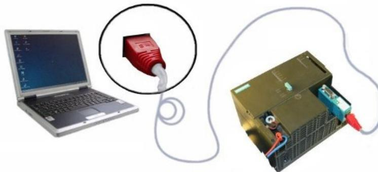
Stecken Sie Ihr LAN-Gerät zunächst mal auf die PPI/MPI/Profibus-Schnittstelle Ihrer SPS. Falls an Ihrer Schnittstelle der SPS bereits ein Buskabel eingesteckt ist, können Sie sich, falls das Kabel über eine Diagnosebuchse verfügt, einfach noch zusätzlich oben auf diese darauf stecken. Möchten Sie ganz ohne SPS arbeiten, können Sie das Gerät auch direkt auf eine Slave-Baugruppe (z. B. ein Panel) stecken.
