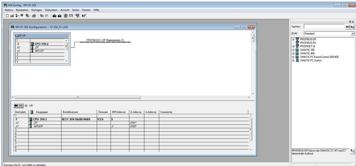
Fügen Sie als nächstes einen CP (z. B. SIMATIC 300 → CP-300 → Industrial Ethernet → CP 343-1 → 6KG7 343-1EX10-0XE0 → V1.0) aus dem Katalog zu Ihrer Steuerung hinzu. Es erscheint nun automatisch der Eigenschaftsdialog des CPs. Dort muss nun die IP-Adresse und Subnetzmaske des Geräts eingetragen werden. Des Weiteren haben Sie die Möglichkeit ein Ethernet-Subnetz zu erstellen oder falls bereits eines vorhanden ist, dieses auszuwählen.
