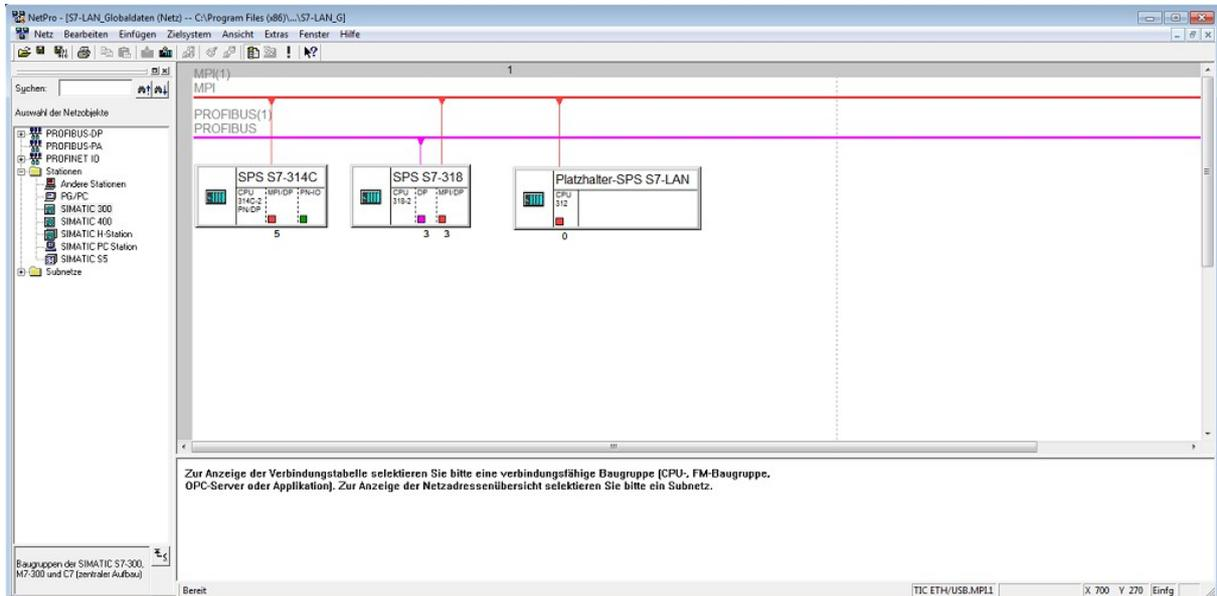
Um nun die Globaldaten zu konfigurieren, führen Sie einen Rechtsklick auf das MPI-Subnetz aus und klicken Sie auf „Globaldaten definieren“. Es öffnet sich nun ein Fenster mit der Globaldaten-Tabelle:
