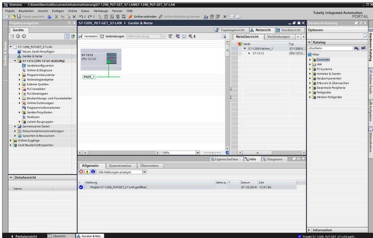
Klicken Sie nun in der Steuerleiste oben auf „Verbindungen“ und wählen Sie dann im Feld dahinter „S7-Verbindung“ aus. Machen Sie dann einen Rechtsklick auf Ihre Steuerung, die Aufträge per PUT/GET versenden soll, und wählen Sie im Kontextmenü den Eintrag „Neue Verbindung hinzufügen“. Daraufhin erscheint folgendes Fenster:
