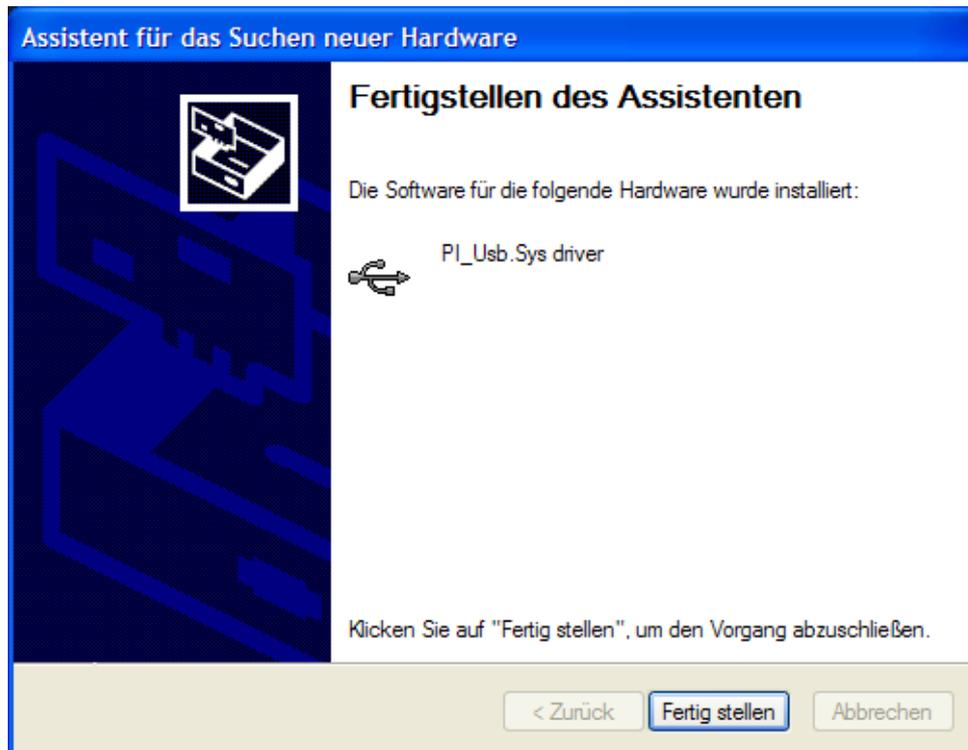
Öffnen Sie anschließend den Geräte-Manager und suchen Sie nach dem Eintrag „PI\_Usb.Sys driver“ unter der Gruppe „USB-Controller“, um die korrekte Installation des Treibers zu prüfen.
