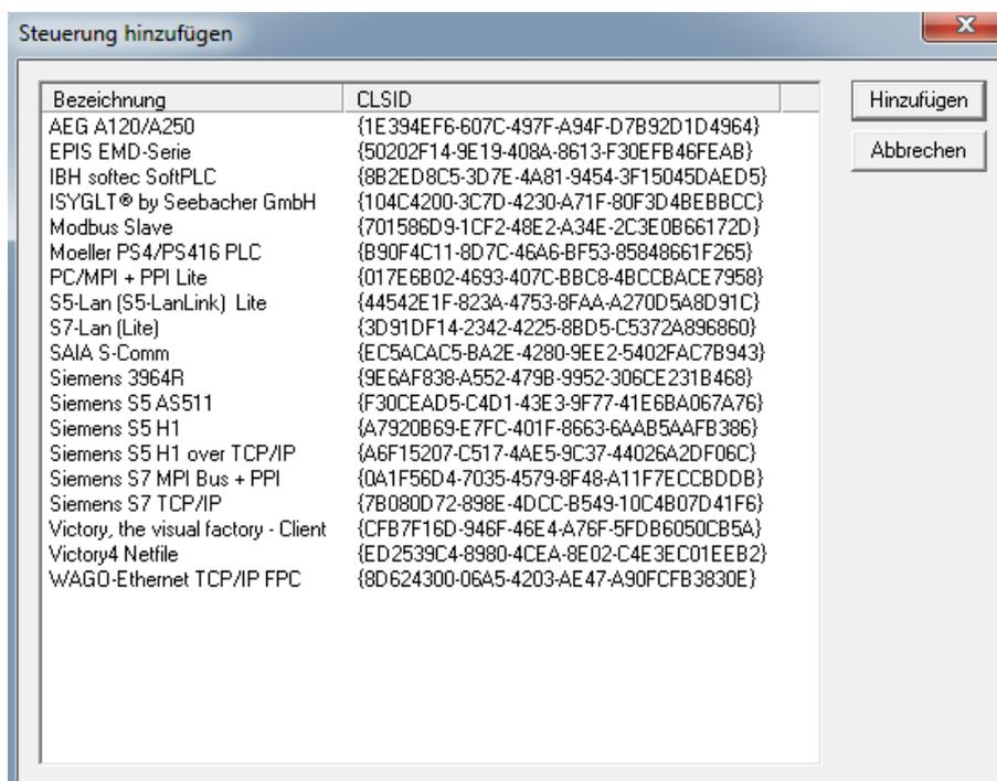
Wählen Sie aus dieser Liste „Siemens S7 TCP/IP“ für den direkten Zugriff auf ein LAN-Gerät oder „Siemens S7 MPI Bus + PPI“ für den seriellen Zugriff (per MPI-II oder virtuellen COM-Port vom PLC-VCOM)
