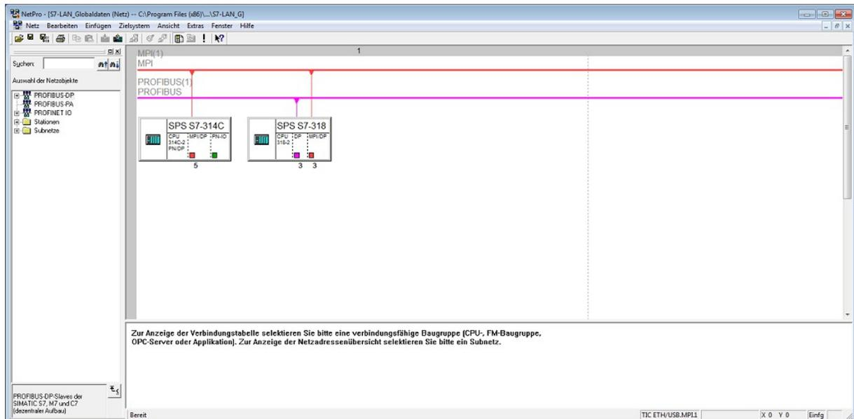
Fügen Sie nun mit Hilfe des Katalogs auf der linken Seite eine neue „SIMATIC 300“ Station hinzu und geben Sie diesem einen passenden Namen zur besseren Identifikation.
