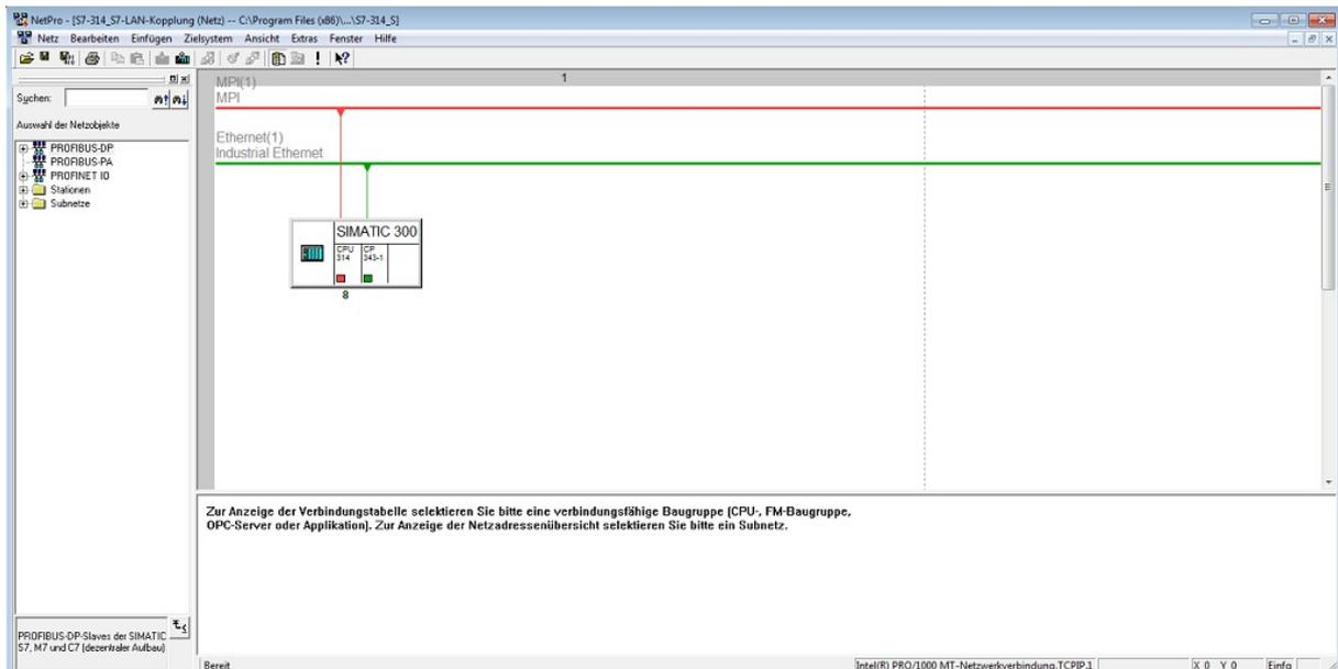
Klicken Sie nun mit der rechten Maustaste auf die CPU Ihrer SIMATIC-Station und wählen Sie hier den Eintrag „Neue Verbindung einfügen“ aus. Daraufhin öffnet sich ein Fenster, in welchem Sie nun oben als Verbindungspartner „(unspezifiziert)“ und unten den Verbindungstyp „ISO-on-TCP-Verbindung“ auswählen müssen:
