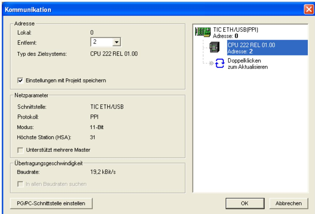
Um die SPS schließlich für die Kommunikation zu verwenden, müssen Sie diese im Feld auf der rechten Seite nur noch auswählen und dann auf den Button „OK“ klicken. Anschließend können Sie MicroWin ganz normal verwenden, um mit Ihrer SPS zu kommunizieren (z. B. Programm laden oder Variablen steuern und beobachten).
