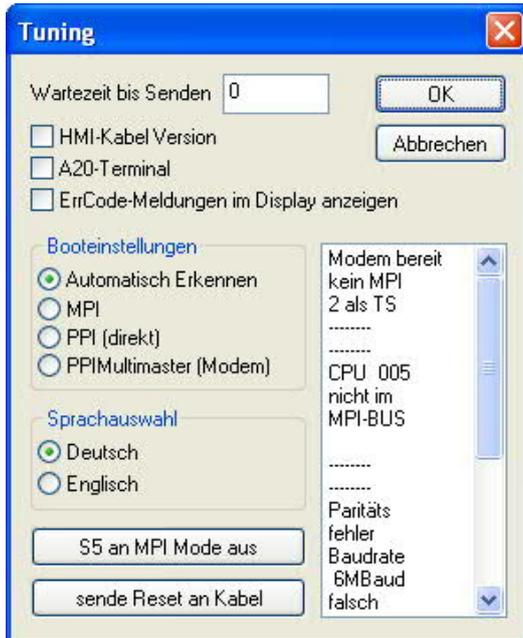
Die folgenden Einstellungsmöglichkeiten werden per Klick auf „OK“ ins Kabel übertragen. Alle Einstellungen werden im EPROM dauerhaft im Kabel gespeichert:
