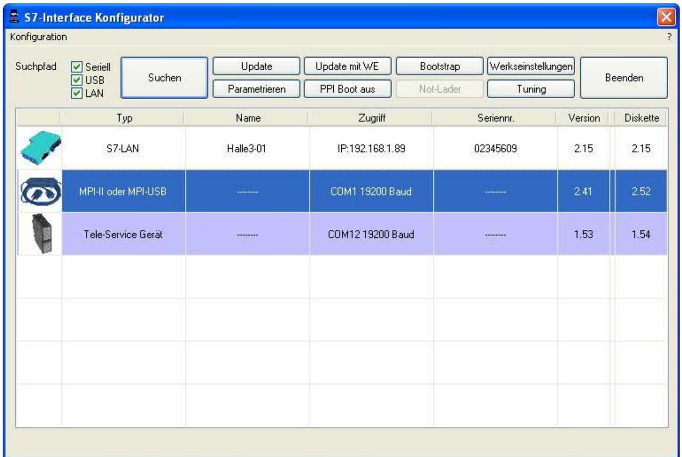
Darunter ist eine Tabelle der gefundenen Geräte. Pro Zeile wird ein Bild, der Typ des Gerätes, der Name (sofern vorhanden), der Zugriffspfad, sofern verfügbar die Seriennummer und die Version im Kabel angezeigt. Auf der rechten Seite wird die aktuelle Betriebssystemversion auf der Festplatte angezeigt.
