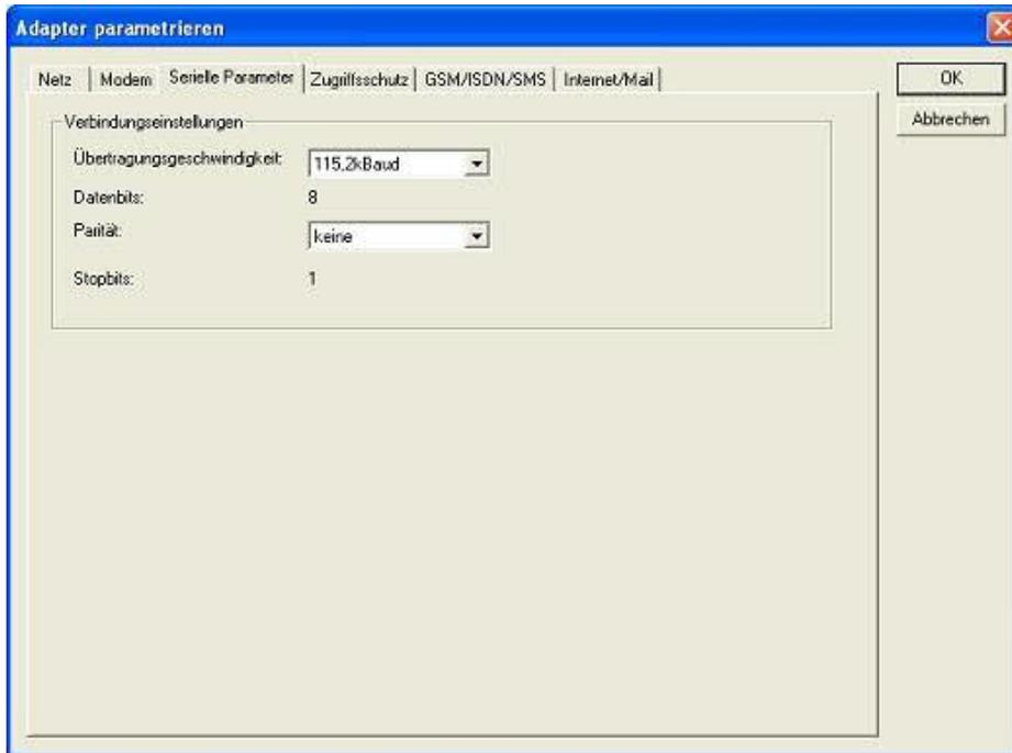
Hier werden die Übertragungsparameter zwischen Modem und dem TS-Adapter eingestellt. Die Übertragungsgeschwindigkeit kann mit den folgenden Werten gewählt werden: 2400, 4800, 9600, 19.2k, 38.4k, 57.6k und 115.2kBaud
