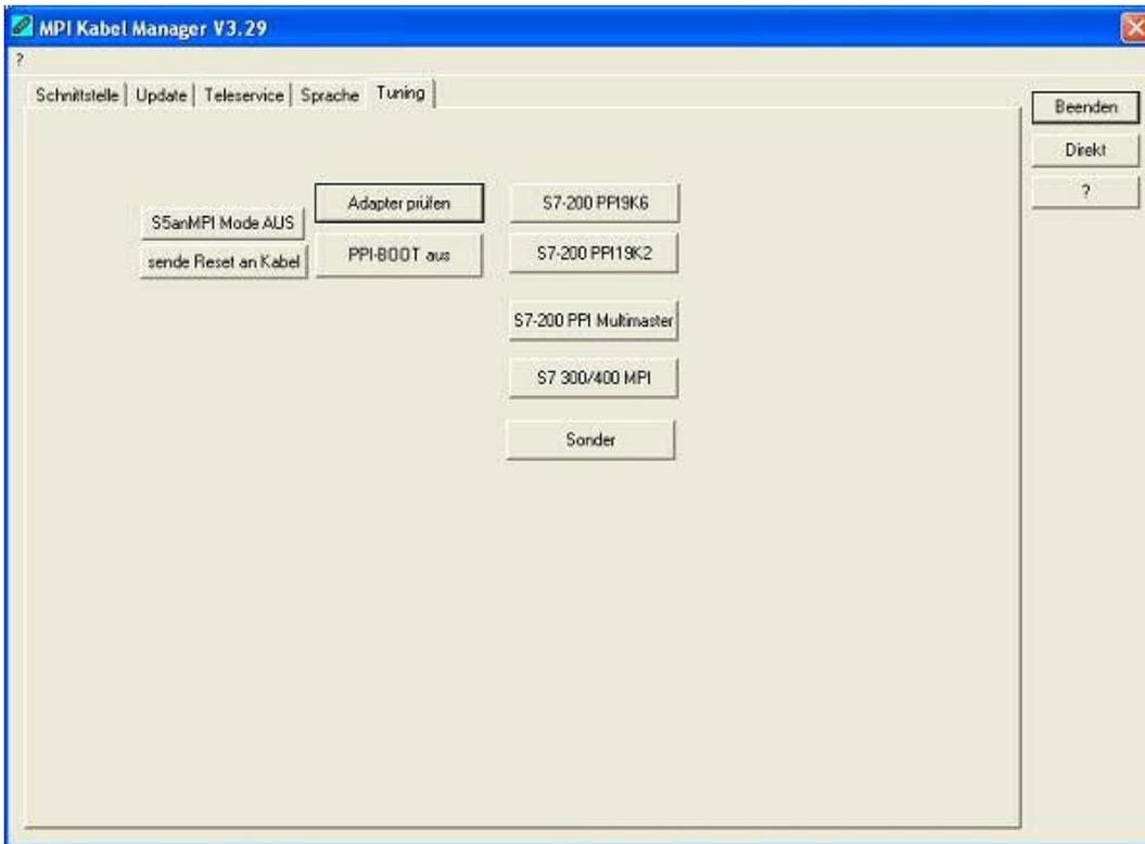
Dieser Reiter wird nur in speziellen Fällen benötigt. Nach einem Klick auf „Adapter prüfen“ wird das Kabel angesprochen und danach der folgende Dialog angezeigt:
