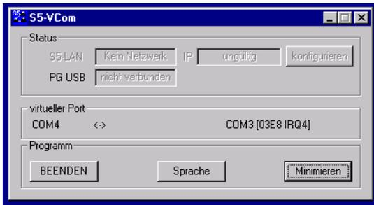
Unter dem Bereich virtueller Port werden auf der linken Seite der COM-Port, der von der Windows-Software verwendet werden kann und auf der rechten Seite der in einer MS-DOS Box zu verwendende COM - Port (IO-Ports) angezeigt.
