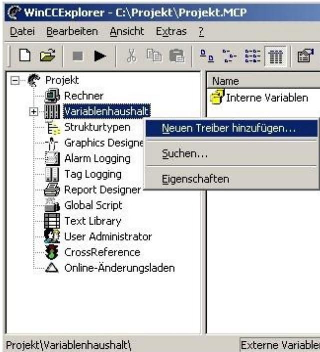
6. Um eine Kommunikation mit der SPS herzustellen muss definiert werden, wie die Software mit der SPS zu kommunizieren hat.
