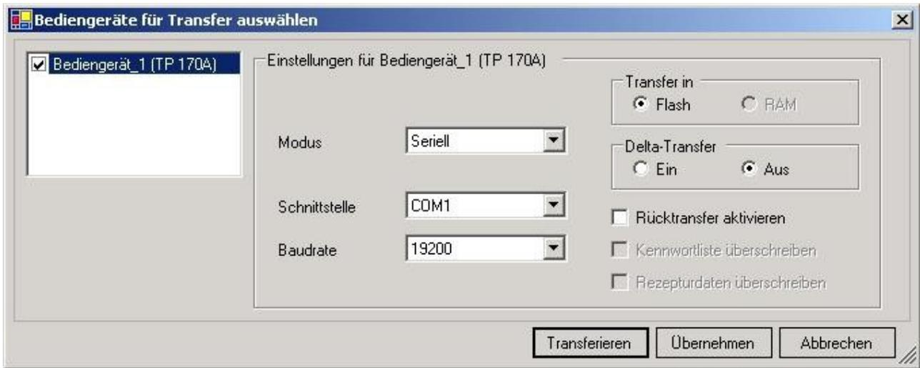
9. Mit „Transferieren“ wird die Kommunikation mit dem Bedienterminal gestartet und Ihr Projekt wird übertragen.
