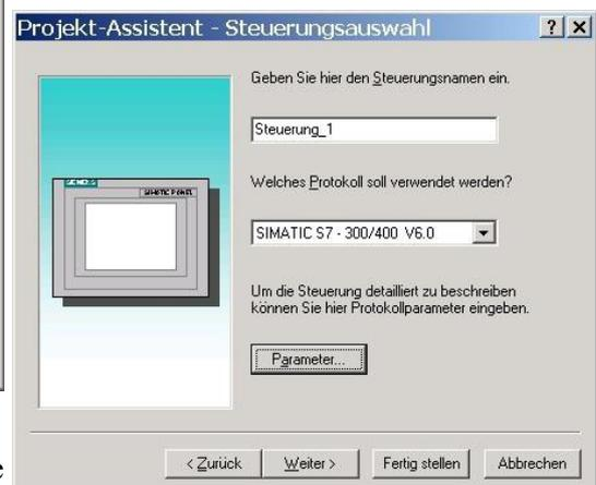
4. Drücken Sie „Weiter“ und Sie gelangen zu einem neuem Dialog indem Sie den Steuerungsname sowie die Steuerung angeben können die Sie verwenden.
