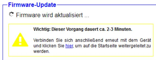
Der nun folgende Update-Vorgang dauert ca. 2-3 Minuten. Im Anschluss sollten Sie auf die Startseite des Geräts weitergeleitet werden. Ist dies nicht der Fall und greifen Sie per WLAN zu, überprüfen Sie bitte, ob die WLAN-Verbindung nicht mehr besteht und bauen Sie diese ggf. erneut manuell auf.
