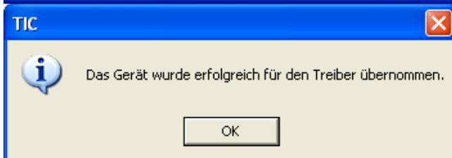
Das kann auch mit einem S5-LAN++ gemacht werden, nur kommt hier kein Dialog für die PG/PC-Schnittstelle, es wird gegebenenfalls der virtuelle Com-Port PLCVCom gestartet falls es noch nicht der Fall ist und diesem der Gerätetyp sowie die IP-Adresse des Gerätes übertragen. Das Programm meldet, ob der Zugriff des TIC im PLCVCom eingeschaltet ist. Falls dies nicht der Fall ist, dann bitte im PLCVCom aktivieren.
