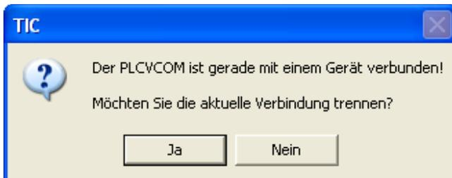
Ist der PLCVCom mit einem anderen Modul verbunden wird dies ist einer entsprechenden Meldung angezeigt. Durch "Ja" wird diese Verbindung getrennt und mit den selektierten Daten neu aufgebaut.
