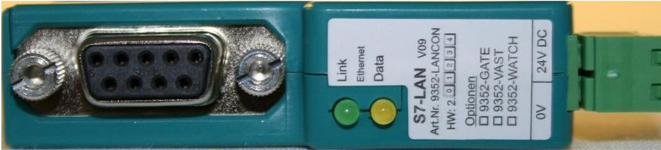
Die seitlichen LEDs verhalten sich genau wie die LEDs der Ethernetbuchse.
