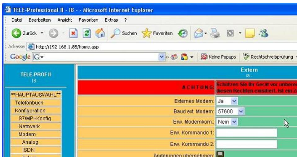
GSM-Modem muss vor Aktivierung bzw. Übernahme der Daten mit Nullmodemkabel an AG-V24-Buchse angeschlossen sein!
