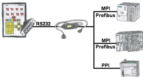
Ihr Panel bietet zum Anschluss einer S7-SPS-Steuerung einen seriellen Port und keinen MPI/Profibus? Schließen Sie das MPI-II-Kabel daran an und Sie sind mit Ihrem Panel online.
