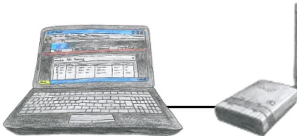
Um ALF zu parametrieren benötigen Sie keine zusätzlichen Treiber oder spezielle Kabel, Sie verbinden sich über LAN oder WLAN mit ALF und über den integrierten WebServer stellen Sie die gewünschte Funktion ein.
