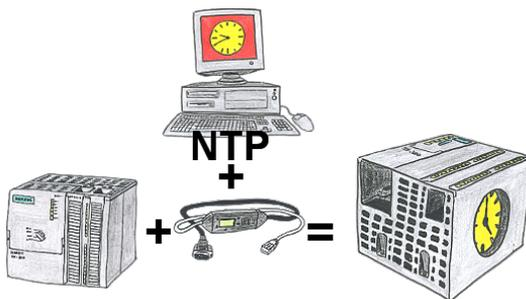
Sie benötigen in Ihrer SPS-Steuerung eine aktuelle Uhrzeit? Kein Problem, mit der NTP-Funktion des MPI-LAN holt sich das Kabel von einem NTP-(Uhrzeit-)Server die aktuelle Uhrzeit und überträgt diese direkt in die parametrisierte SPS-Steuerung oder auch in einen DB zur Weiterverarbeitung.
