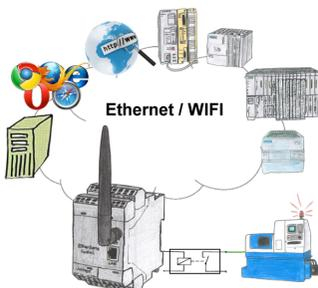
Schalten Sie mit dem EtherSens Control mit Relais-Ausgang bequem und direkt über LAN oder WIFI bis zu 230VAC/16A, schaltbar über Web-Browser, TCP/IP-Protokoll oder SPS-gesteuert. Gleichzeitig protokollieren Sie die Schaltzustände auf der optionalen SD-Karte oder über den FTP-Server.
