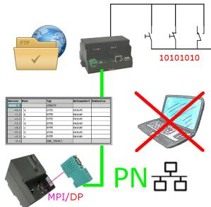
Über digitalen Eingang getriggerte DB-Sicherung/-Wiederherstellung ohne zusätzlichen PC über MPI/Profibus auf FTP-Server
