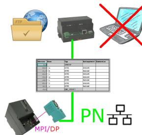
S7-SPS getriggerte DB-Sicherung/-Wiederherstellung ohne zusätzlichen PC über MPI/Profibus auf FTP-Server
