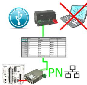
S5-SPS getriggerte DB-Sicherung/-Wiederherstellung ohne zusätzlichen PC über PG-Buchse und Ethernet auf USB-Stick
