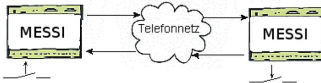
Über ein Festnetz- oder Mobiltelefon wird der MESSI angerufen. Mit einer direkten Sprachmeldung und DTMF-Tonwahl wird dann der entsprechende Ausgang geschaltet. Ist ein Schaltvorgang zustande gekommen, wird dieser per Sprachausgabe bestätigt.
